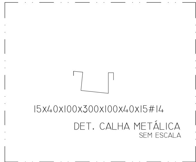
DETALHE DET-01 DA CALHA
