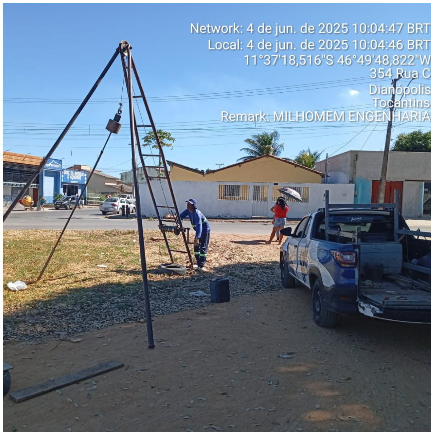
Figura 01 – Equipamento de sondagem SPT.
